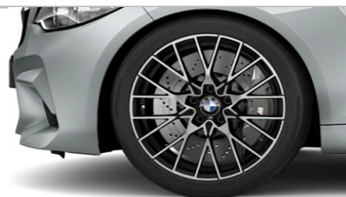
M2 Competition: pidurikettad ees 400mm x 36mm / taga 380mm x 28mm, piduri suuport halli värvi ja M tähisega
